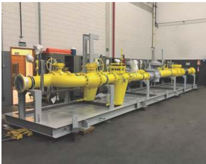
Estação de Regulação de Pressão (ERP) fornecida para UTE Prosperidade. Cliente: Imetame - Cliente Final: BahiaGás
